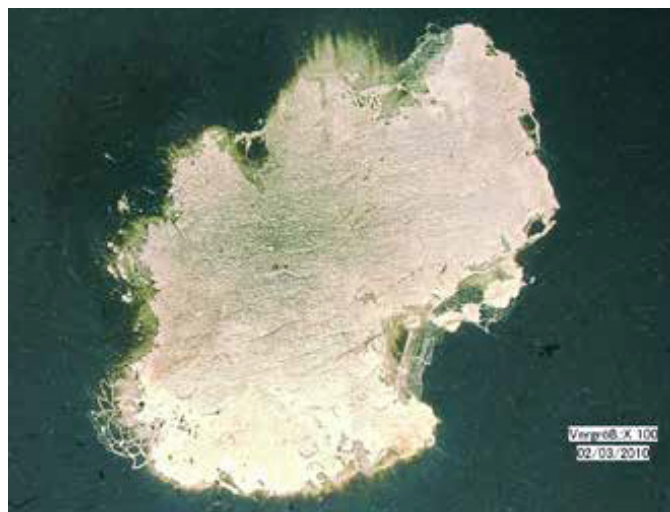
Selbstheilungsprozess in einer typischen metallisierten Folie
