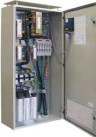
Blindleistungs-Kompensationsanlagen sind Niederspannungsanlagen, die im Rahmen der Gebäudeinstallation errichtet werden. Sie sind als abgeschlossene Einheit zu sehen. Die Anlagen werden auf die bestehenden Gebäudeinstallation aufschaltet und können ohne größere Anpassungen auch nachträglich installiert werden. Anlagen zur Blindleistungs-Kompensation und deren Anwendung sind heute schon als reife Technologie anzusehen.
