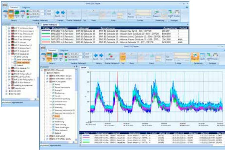
Im physikalischen Systembaum sind zu jedem Gerät Standardauswertungen hinterlegt, die dem Anwender auch ohne Projektierung die Visualisierung der aufgezeichneten Messdaten ermöglichen.
