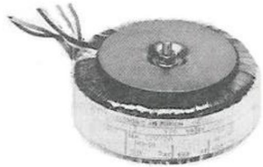
**Für 230V-Netzanschluss müssen die beiden 2x 115VAC Primärwicklungen unbedingt in Serie geschaltet werden!**
